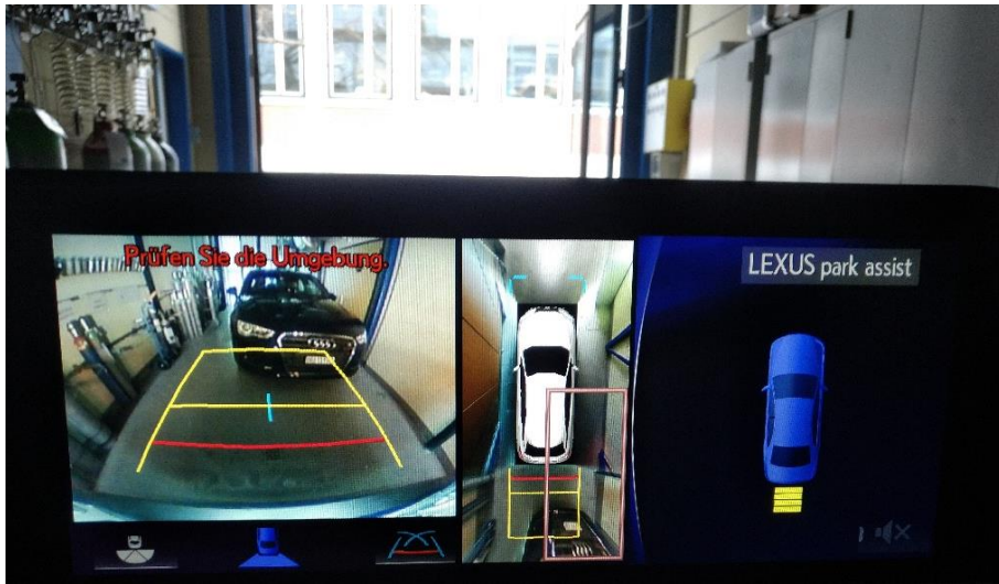
Abbildung 2: Bildschirm in einem Lexus Rx 450h mit park assist: Bild der Rückfahrkamera (Links), 360° Birds Eye View (Mitte) und Daten der Ultraschallsensoren (Rechts).
