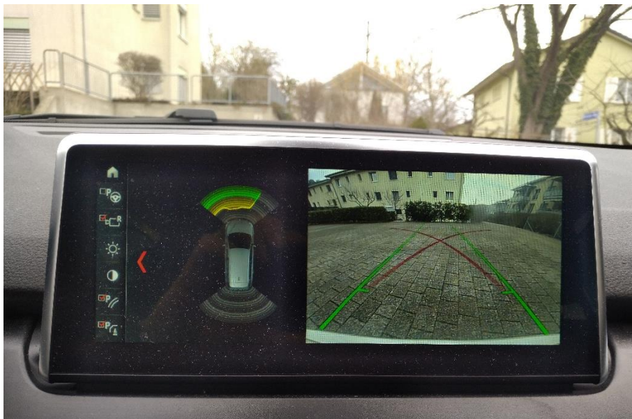
Abbildung 3: Bildschirm in einem BMW-Serie 2: Ultraschallsensoren (links), Rückfahrkamera mit überlagerten Informationen des aktuellen (grün) und maximalen Kurvenradius (rot) (rechts).
